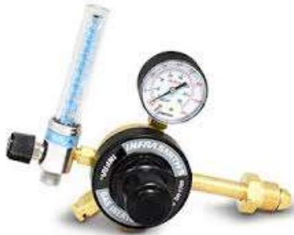
La rosca del regulador es el factor más obvio en la selección. De manera general hay dos sistemas de roscado diferentes: roscas internas y roscas externas. Un regulador con rosca externa simplemente no se ajustará a un sistema con rosca externa, y viceversa. No hay adaptadores de conversión. Si terminan con una configuración incompatible, la única solución es reemplazar el regulador.
